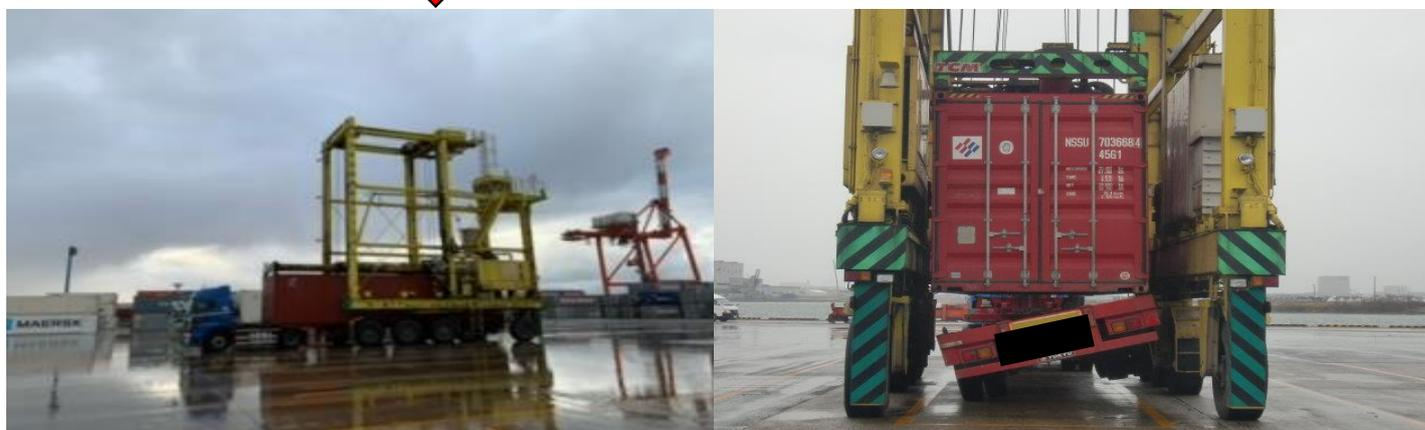
キャリアが降ろしてバックしたら、ホーンを鳴らしますので前進してロックを解除して下さい
